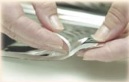
4. Maak de beschermlaag gedeeltelijk los en vouw deze om.
