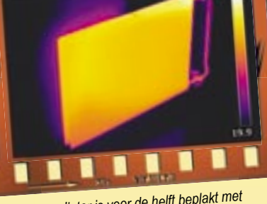
De radiator is voor de helft beplakt met HR-folie. Er is alleen nog gloed op de muur achter het deel dat niet is beplakt.
